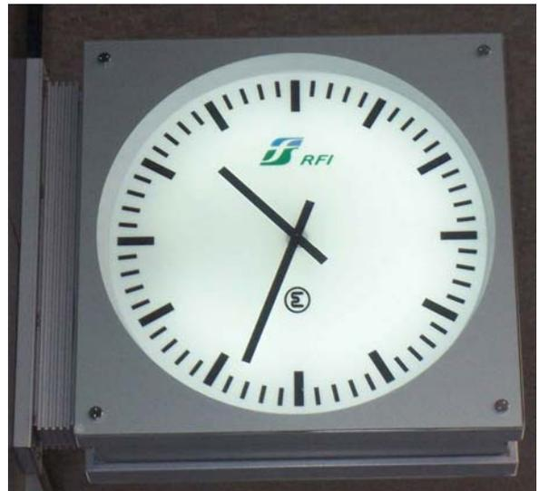
Nell'orologio in versione "intelligente" l'ora corretta sarà garantita dal microprocessore della centrale master NTP, che verificherà il giusto posizionamento delle lancette (mediante encoder ottico).
